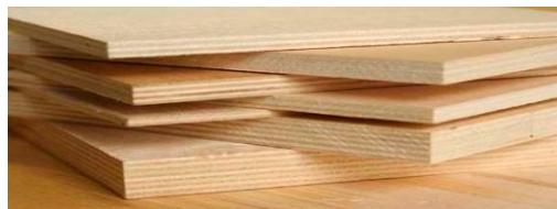
**ФАНЕРА** шлифованная ФК 15 мм- влагостойкая фанера, состоит из склеенных между собой тонких слоев шпона. При изготовлении фанеры шлифованной 12мм сорта ФК используется карбамидный клей, благодаря чему она является экологически безопасной и нетоксичной.
